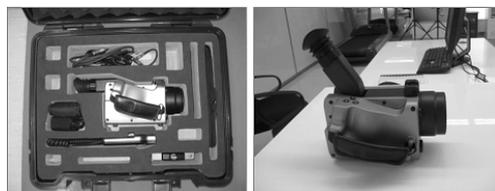
图1 红外温度测试仪
